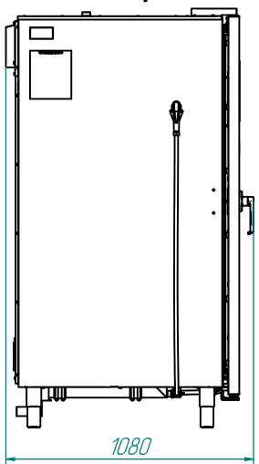
Конвекционная печь электрическая КЭП-16 предназначена для приготовления пищи на предприятиях общественного питания. Управление осуществляется через панель управления, расположенное на двери печи. На панели управления имеются кнопки выбора режима работы и индикаторы, отображающие выбранный режим. В конструкции двери используется ручка с мезанизмом байонет. Дверь имеет возможность фиксации своего положения в открытом состоянии.
